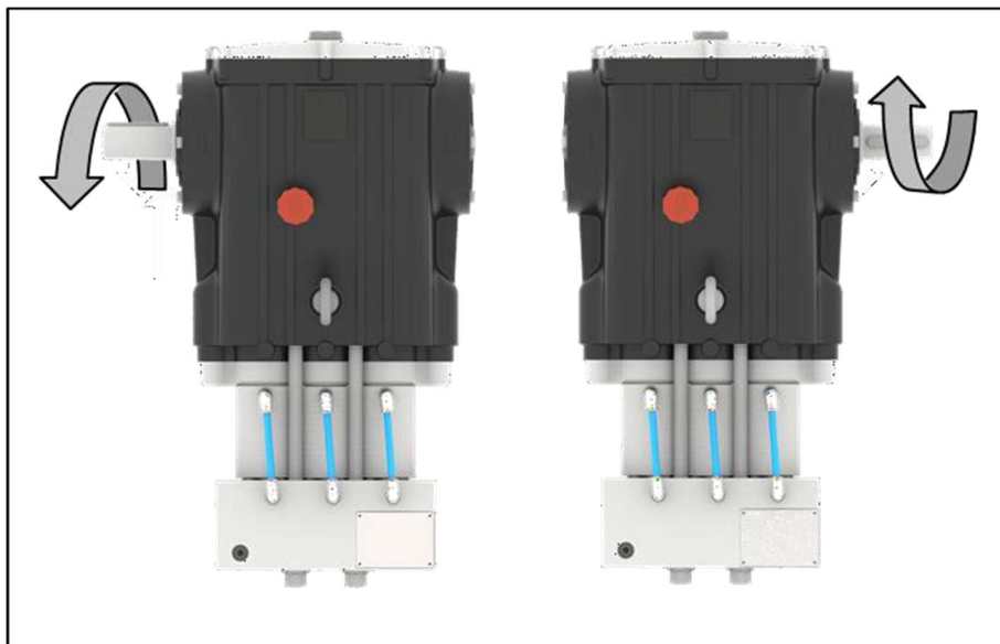
图16: 左、右泵的标准驱动旋转方向
